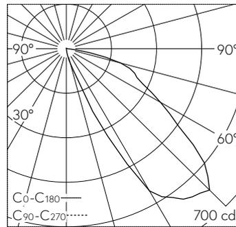
LED 3000 K 6.4 W 461 lm-h / CIE Flux 27 72 94 100 100 / A20 selon DIN 5040
