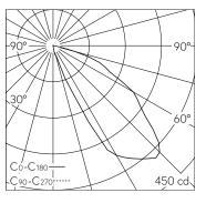
LED 4000 K 4 W 305 lm-h / CIE Flux 28 74 97 100 100 / A20 selon DIN 5040
