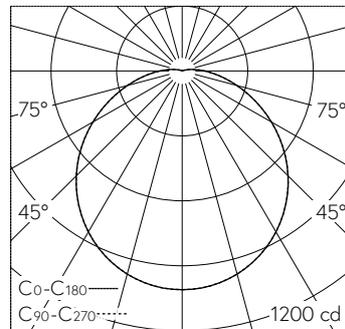
LED 3000 K 27.2 W 3242 lm-h / CIE Flux 44 74 91 97 100 / A30 selon DIN 5040
