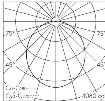
LED 4000 K 26.5 W 2592 lm-h / CIE Flux 46 76 92 97 100 / A40 selon DIN 5040
