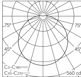
LED 4000 K 15.7 W 1524 lm-h / CIE Flux 43 72 90 96 100 / A30 selon DIN 5040
