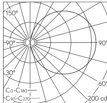
LED 4000 K 6.6 W 564 lm-h / CIE Flux 13 37 66 50 100 / C11 selon DIN 5040
