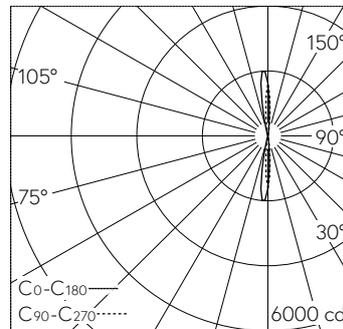
LED 4000 K 5.5 W 187 lm-h / CIE Flux 98 100 100 50 100 / C84 selon DIN 5040
