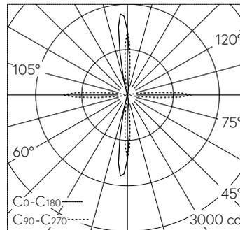
LED 4000 K 9.6 W 375 lm-h / CIE Flux 46 50 55 50 100 / C32 selon DIN 5040
