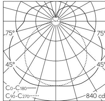
LED 3000 K 27 W 3824 lm-h / CIE Flux 36 65 86 73 100 / B31 selon DIN 5040
