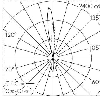
LED 4000 K 9 W 313 lm-h / CIE Flux 89 99 100 70 100 / B84 selon DIN 5040
