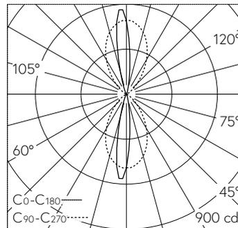
LED 4000 K 11.5 W 435 lm-h / CIE Flux 89 98 100 50 100 / C84 selon DIN 5040
