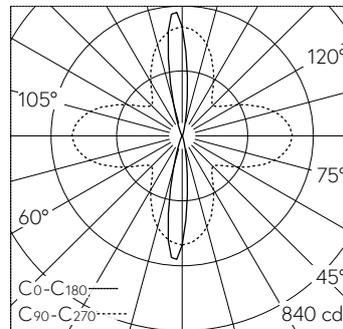
LED 3000 K 23 W 866 lm-h / CIE Flux 47 61 78 50 100 / C32 selon DIN 5040
