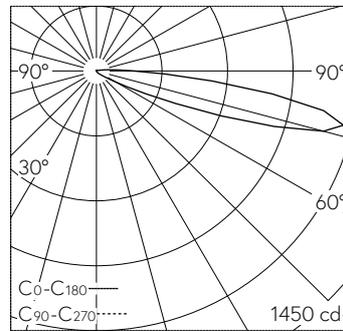
LED 3000 K 10.7 W 557 lm-h / CIE Flux 1 4 34 93 100 / A11 selon DIN 5040
