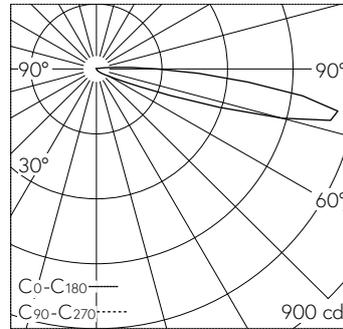
LED 3000 K 6.1 W 301 lm-h / CIE Flux 1 4 28 91 100 / A11 selon DIN 5040
