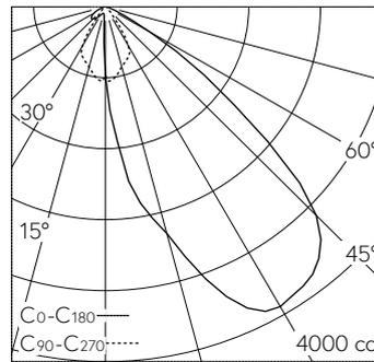
LED 4000 K 36.2 W 2910 lm-h / CIE Flux 70 98 100 100 100 / A60 selon DIN 5040
