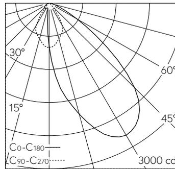
LED 4000 K 19.7 W 1925 lm-h / CIE Flux 69 95 99 100 100 / A60 selon DIN 5040
