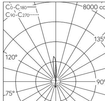
LED 3000 K 19.5 W 671 lm-h / CIE Flux 48 62 79 59 100 / C42 selon DIN 5040
