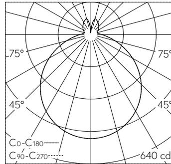
LED 4000 K 15.5 W 2184 lm-h / CIE Flux 44 75 92 84 100 / B42 selon DIN 5040
