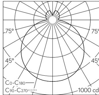
LED 3000 K 35 W 3343 lm-h / CIE Flux 42 73 91 81 100 / B32 selon DIN 5040
