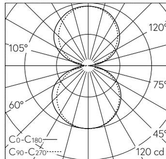
LED 3000 K 8.8 W 512 lm-h / CIE Flux 43 74 93 51 100 / C33 selon DIN 5040
