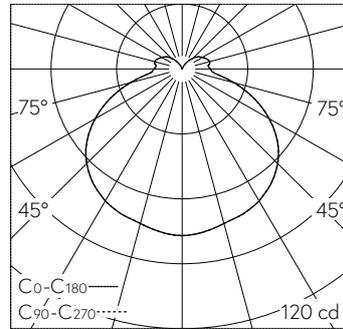
LED 4000 K 4.8 W 387 lm-h 128°/128° / CIE Flux 38 69 89 82 100 / B31 selon DIN 5...
