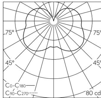
LED 3000 K 4.7 W 422 lm-h / CIE Flux 24 51 76 61 100 / B11 selon DIN 5040
