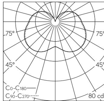
LED 3000 K 3.9 W 367 lm-h / CIE Flux 24 51 76 65 100 / B11 selon DIN 5040
