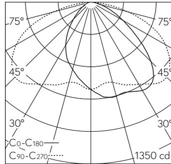
LED 4000 K 19 W 2389 lm-h / CIE Flux 44 79 96 100 100 / A40 selon DIN 5040
