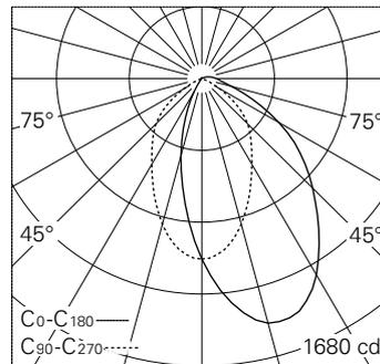
LED 3000 K 22.8 W 1721 lm-h / CIE Flux 62 88 97 99 100 / A50 selon DIN 5040
