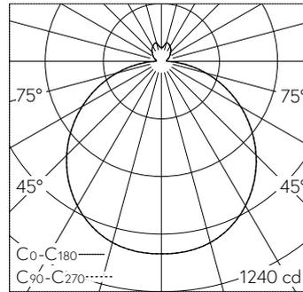
LED 3000 K 35 W 3518 lm-h / CIE Flux 45 76 93 90 100 / A43 selon DIN 5040
