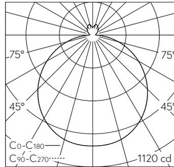
LED 3000 K 35 W 3201 lm-h / CIE Flux 45 76 93 90 100 / A43 selon DIN 5040
