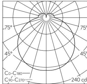
LED 3000 K 8.4 W 839 lm-h / CIE Flux 40 70 89 82 100 / B31 selon DIN 5040
