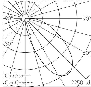
LED 2700 K 35.40 W 1403 lm-h / CIE Flux 37 73 92 100 100 / A30 selon DIN 5040
