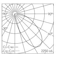
LED 2700 K 35.4 W 1403 lm-h / CIE Flux 37 73 92 100 100 / A30 selon DIN 5040
