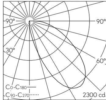
LED 3000 K 35.4 W 1459 lm-h / CIE Flux 37 73 92 100 100 / A30 selon DIN 5040
