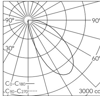
LED 4000 K 35.4 W 1612 lm-h / CIE Flux 37 73 92 100 100 / A30 selon DIN 5040
