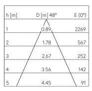
LED 2700 K 27.9 W 1309 lm-h 48° / CIE Flux 98 100 100 100 100 / A80 selon DIN 5...
