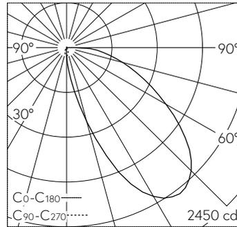
LED 4000 K 33.2 W 1531 lm-h / CIE Flux 37 73 92 100 100 / A30 selon DIN 5040
