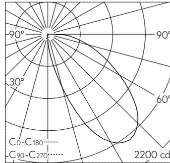
LED 3000 K 33.2 W 1385 lm-h / CIE Flux 37 73 92 100 100 / A30 selon DIN 5040
