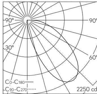
LED 2700 K 35.4 W 1403 lm-h / CIE Flux 37 73 92 100 100 / A30 selon DIN 5040
