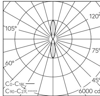
LED 3000 K 17,6 W 775 lm-h / CIE Flux 86 96 99 50 100 / C74 selon DIN 5040
