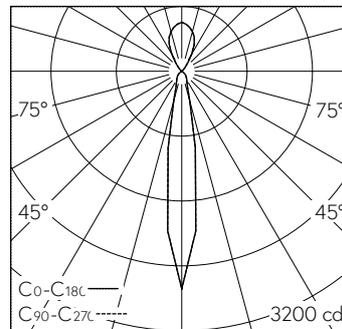
LED 2700 K 17,6 W 287 lm-h / CIE Flux 87 100 100 50 100 / C84 selon DIN 5040
