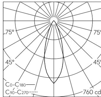
LED 8.9 W 266 lm-h / CIE Flux 91 98 100 99 100 / A80 selon DIN 5040
