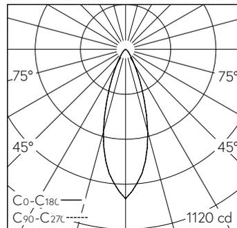
LED 12,4 W 396 lm-h / CIE Flux 91 98 100 99 100 / A80 selon DIN 5040
