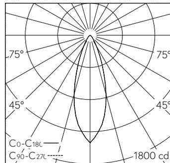
LED 4000 K 12,9 W 641 lm-h / CIE Flux 91 98 100 99 100 / A80 selon DIN 5040
