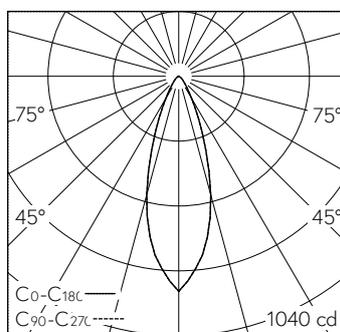
LED 2700 K 8,1 W 367 lm-h / CIE Flux 91 98 100 99 100 / A80 selon DIN 5040
