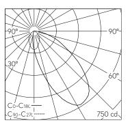
LED 2700 K 9,1 W 571 lm-h / CIE Flux 49 85 98 100 100 / A40 selon DIN 5040
