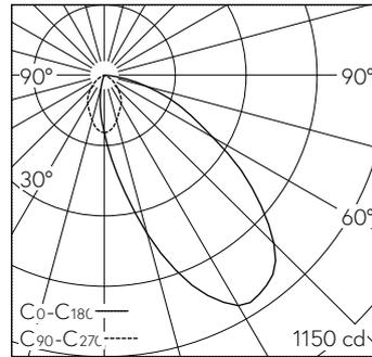
LED 4000 K 13,7 W 855 lm-h / CIE Flux 49 85 98 100 100 / A40 selon DIN 5040
