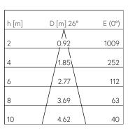
LED 2700 K 17,6 W 1298 lm-h 26° / CIE Flux 99 100 100 100 100 / A80 selon DIN 5040
