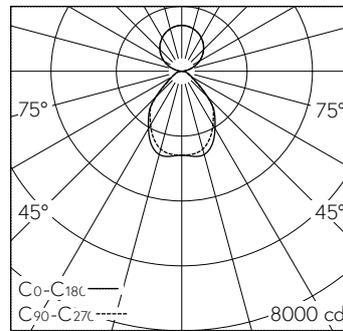
LED 3000 K 72 W 8887 lm-h / CIE Flux 67 90 97 55 100 / C63 selon DIN 5040
