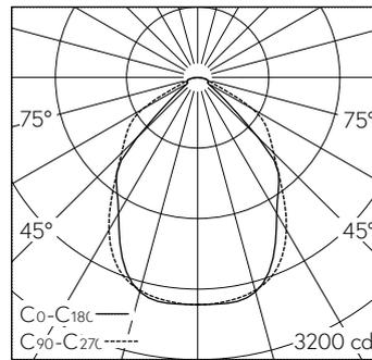
LED 3000 K 48 W 4704 lm-h / CIE Flux 66 91 98 100 100 / A60 selon DIN 5040
