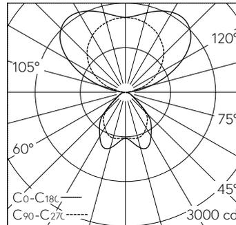
LED 4000 K 80 W 9418 lm-h / CIE Flux 63 89 97 28 100 / D63 selon DIN 5040
