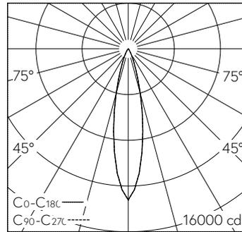
LED 4000 K 25 W 2696 lm-h / CIE Flux 99 100 100 99 100 / A81 selon DIN 5040
