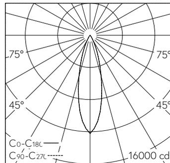
LED 3000 K 37 W 3470 lm-h / CIE Flux 99 100 100 99 100 / A81 selon DIN 5040
